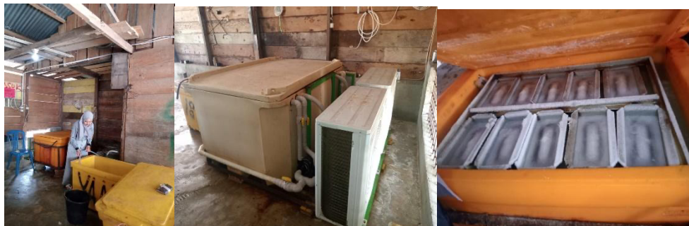
Gambar 9. pemasukan air, mesin pendingin, pencetakan batu es.
